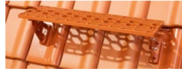
Bevor die Kurz-/Langrosthalterung auf die Grundpfanne montiert werden kann, muss die aufgeschraubte Mutter mit einem 13-mm-Schraubenschlüssel gelöst werden.
