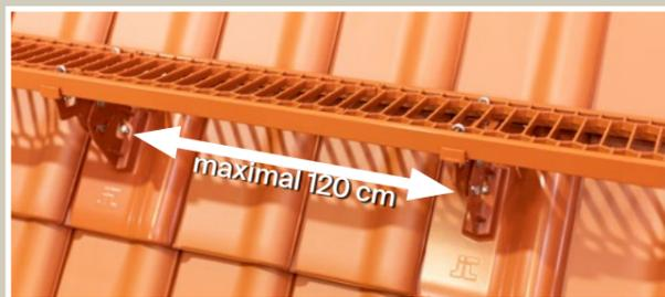
Je Endlos-Laufrost werden zwei Laufrost-Halterungen benötigt. Der Abstand zwischen diesen darf maximal 120 cm betragen.
